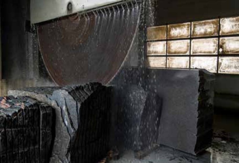
Store granitblokke saves til håndterbare plader
